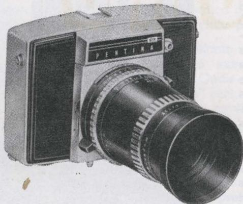
**PENTINA "E"** — Câmera foto 24x36 mm, mono-reflex, prismática, transporte por alavanca, velocidade 1/500, obturador central tipo Compur, sincronismo para flashes M.X., com lente de Fresnel e estigmômetro, com objetiva Carl Zeiss Jena TESSAR 2,8/50. Objetivas intercambiáveis de 30 à 135 mm.
